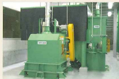
④ 缶類磁選機・缶類アルミ選別機 磁石の力を利用してスチール缶を選び出し、高速回転する磁石の反発力でアルミ缶を選び分けれます。
