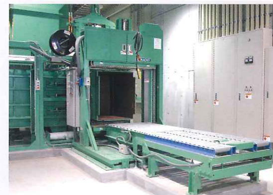
⑥ ペットボトル・その他プラスチック圧縮梱包機 選別したペットボトル・その他プラスチックを機械で押し固め、1m角の立方体状にしたのちフィルムで包みヒモで縛って梱包します。
