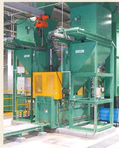
⑤ 缶類金属圧縮機 選り分けたスチール缶・アルミ缶をそれぞれ機械で立方体に押し固めたものを、一旦ため置きしてから再生工場へ運び出し再生資源に利用します。
