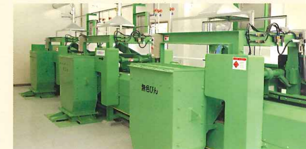
⑦ びん類手選別コンベヤ びん類から手作業により異物を取り除き、色ごとに分別します。
