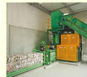
⑨ 圧縮梱包機 ダンボール・新聞・雑誌・紙パック・その他紙類をそれぞれ機械で押し固め、押し出すことでブロック状に成形し番線(ワイヤー)で縛って梱包します。
