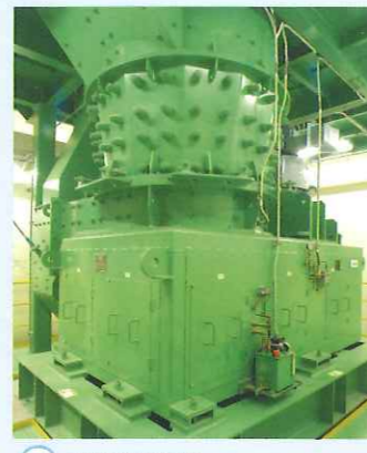
② 回転式破砕機 大まかに砕かれたごみを縦型の高速回転式破砕機で、たたき・砕き・切断してさらに細かくします。
