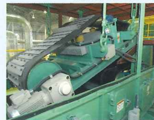
③ 破砕物磁選機 磁石の力を利用して鉄分を選び出します。
