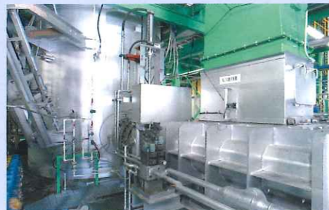
7 溶融炉 溶融炉に投入されたごみは1500℃以上の高温で溶融され、ごみに含まれる炭素、水素を一酸化炭素ガスと水素ガスに変換、エネルギーガスとして回収します。また、不燃物は高品質のスラグに生まれかわります。
